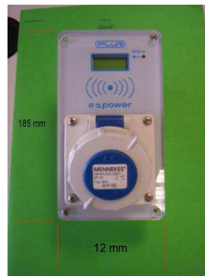
A négy csatlakozódugasz egyike, amelyet a töltőállomásra terveznek
