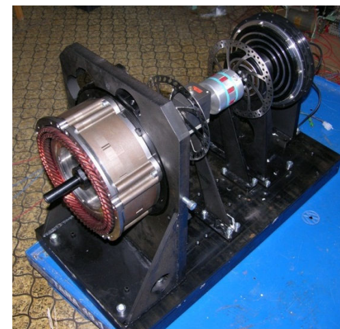
A PMS motor kísérleti vizsgálata, járműves szimulációja
